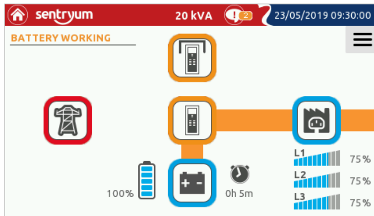
Домашняя страница, на которой отображается состояние АККУМУЛЯТОРНАЯ БАТАРЕЯ В РАБОТЕ.
